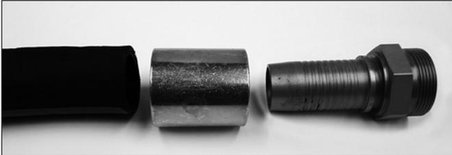
1. Utiliser des composants de système adaptés au diamètre nominal et au type de tuyau correspondants.
